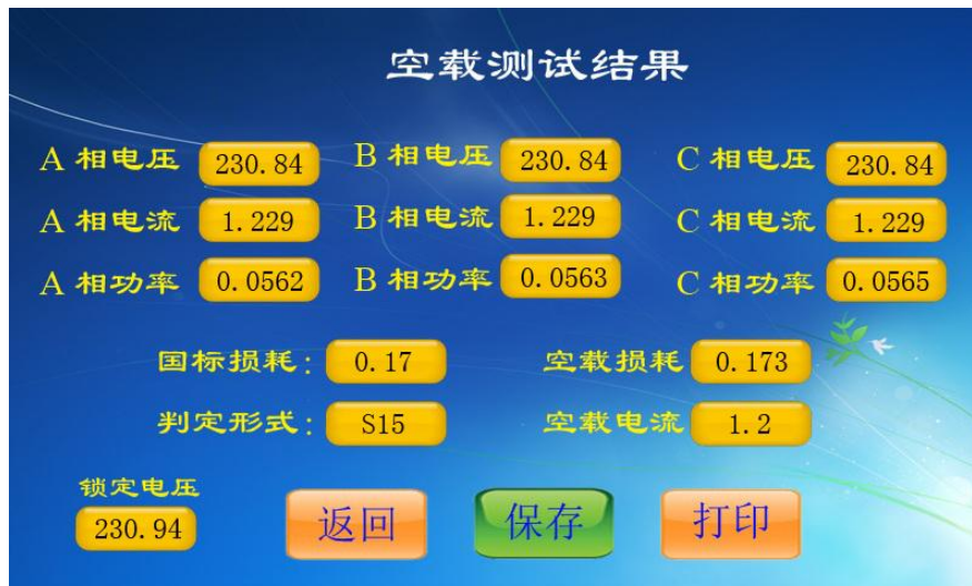
图 12、三相空载测试结果
