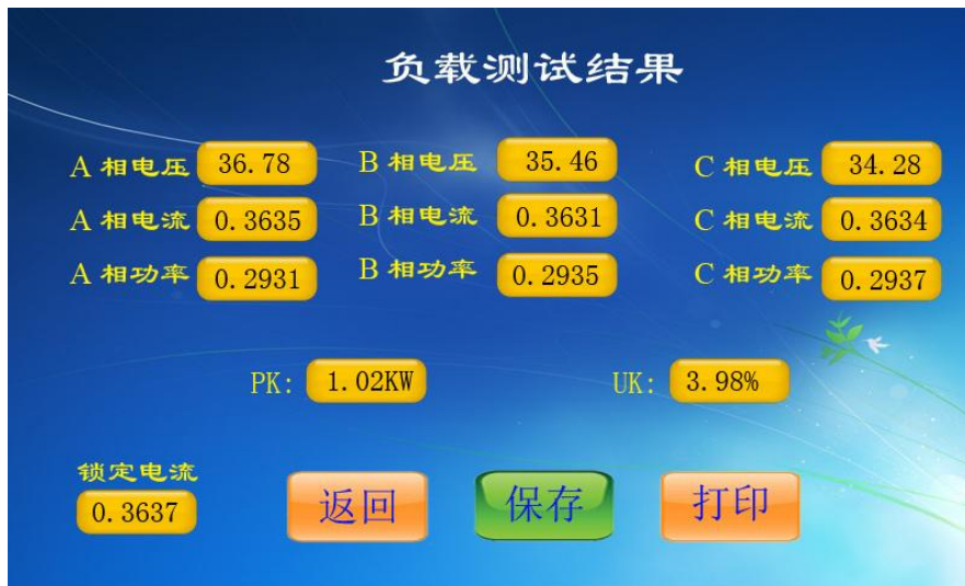
图 9、三相负载测试结果
