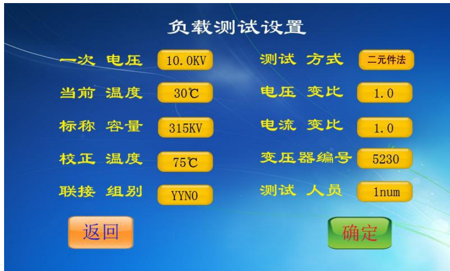
图 8、三相负载测试设置
